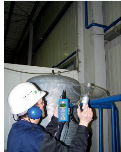
Ortung mit Parabolspiegel für Distanzen von 30-40 Metern
