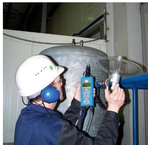
Ortung mit Parabolspiegel für Distanzen von 30 – 40 Metern
